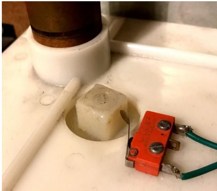
(Hopper i hvilestilling. Bryteren er ikke mekanisk lukket)
